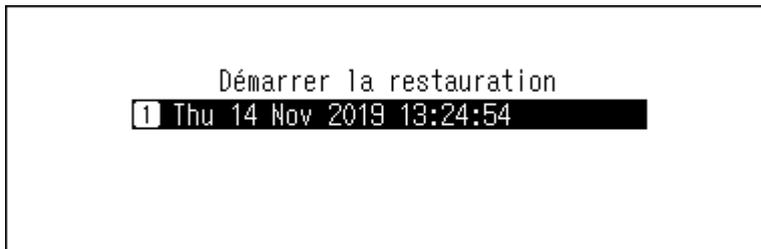
**6** Utilisez les boutons Haut/Bas pour sélectionner « Restaurer les données », puis appuyez sur le bouton Menu/Entrée. Si vous sélectionnez « Restaurer la configuration », les paramètres, hormis le nom d'hôte, peuvent également être restaurés à partir des paramètres sauvegardés.
